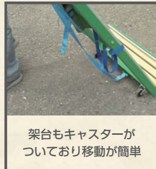
設置は脚パイプを 広げ架台をのせるだけ
